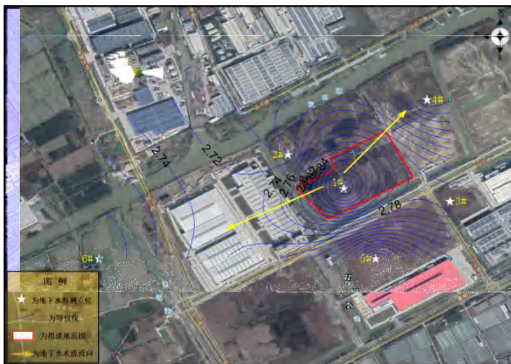
图 5.2-25 地下水潜水等水位线和流向图
